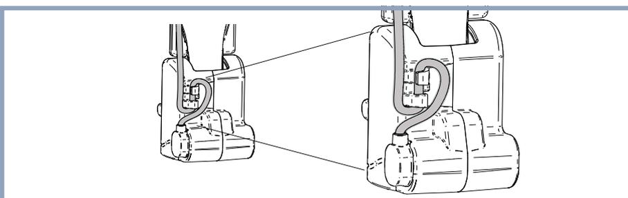
Se utilizar um PDPS, fixe os cabos à parte de trás da armação do *Quick-Connect*, conforme mostrado.
