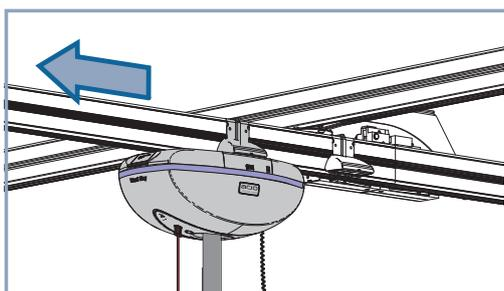
Depois de o elevador passar a estação de desativação, a porta solta-se, permitindo que a calha transversal se desloque no eixo Y.
