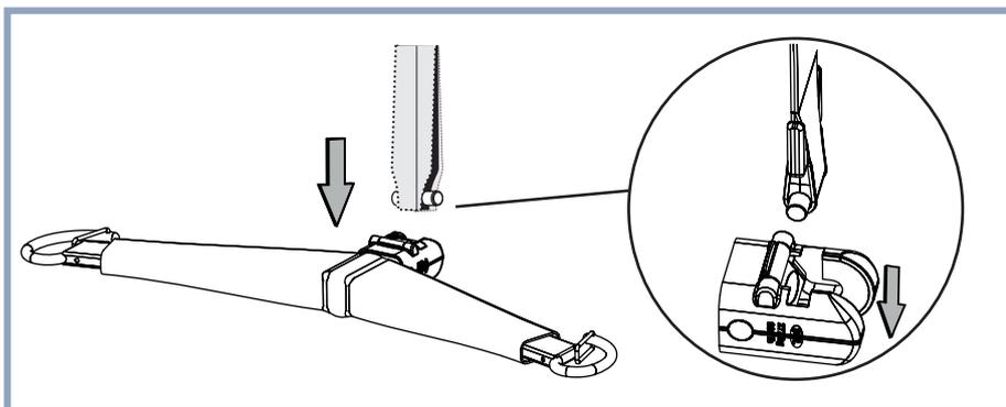
Puxe a barra de suporte/ balança para baixo, separando-a do *Quick-Connect*.
