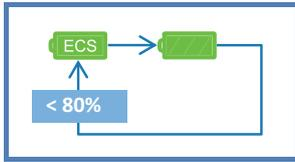
Caso seja ativada uma função durante o processo de carregamento, o ícone ECS desaparecerá e o LED verde ilumina-se com uma luz estável. Quando o botão da função é libertado, o dispositivo tentará reconectar-se ao sistema ECS após cerca de 20 segundos, apenas caso o nível de carga da bateria ainda esteja abaixo dos 80%.
