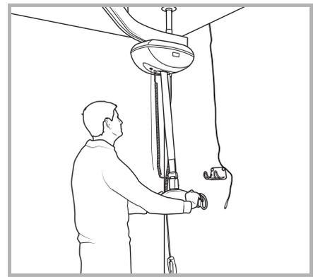
Remova manualmente a barra de suporte do gancho de parede. Coloque por baixo do elevador e permita que a extensão retome a tensão gradualmente.
