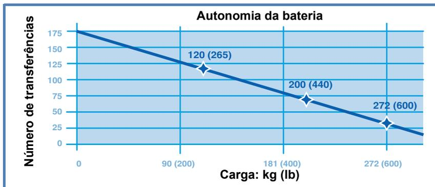
Este gráfico ilustra a relação existente entre o número de elevações que podem ser realizadas antes de atingir o nível de carga crítica da bateria versus a carga a ser elevada.
