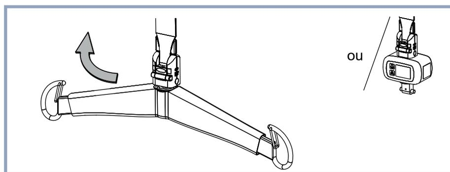
Rode a barra de suporte/ balança para cima na direção do trinco, dependendo daquela que pretende remover.
