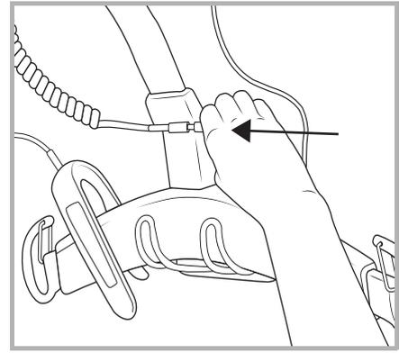
Conecte ou ligue o cabo do carregador ao conector do Sistema de carregamento de parede (WCS).
