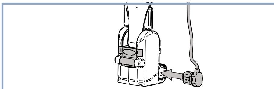
Se utilizar um PDPS, ligue o cabo. O cabo é utilizado para ligar o elevador à barra de suporte. Não existe ligação para o cabo na balança.
