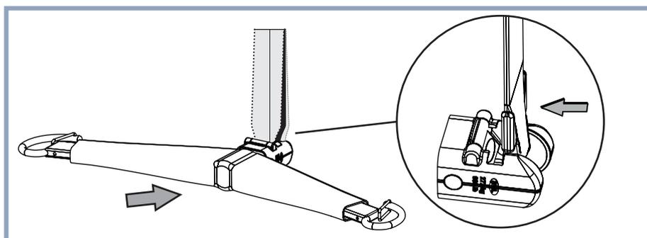
Mova a barra de suporte/ balança, para desencaixar o gancho do pivô.
