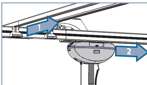
Mova ambos, o elevador e a calha transversal no eixo Y, para alinhar a calha transversal com a calha de chegada. Esta ação será detetada pela porta, que bloqueará as duas calhas e permitirá a passagem do elevador.
