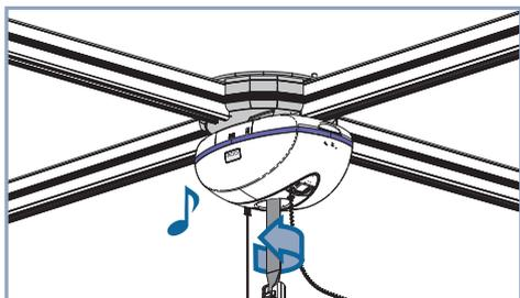
Depois de detetar o elevador, o acessório *Turntable* confirma com um sinal sonoro e começa a girar para se alinhar com a outra trajetória da calha.
