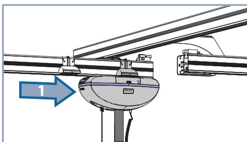
Desloque o elevador no eixo X até à extremidade da calha transversal onde a porta está instalada, no lado da calha transversal. O elevador ficará automaticamente em contacto com a estação de ativação.
