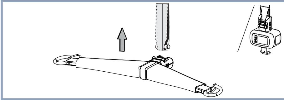
Alinhe o trinco do *Quick-Connect* da barra de suporte/balança com o gancho.
