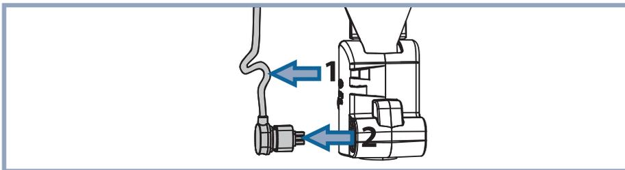
Se utilizar um PDPS, solte o cabo da parte de trás da armação do *Quick-Connect* e, em seguida, desligue o cabo.
