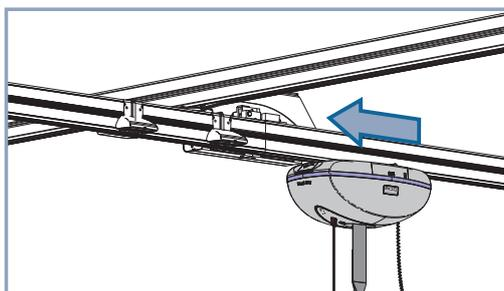
Ao entrar no sistema X-Y a partir da calha de entrada, a calha transversal fica no lugar. Passe o elevador através da porta.
