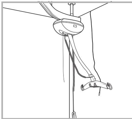
Retire o controlo remoto da barra de suporte e deixe-o pendurado livremente para evitar um recuo inesperado.
