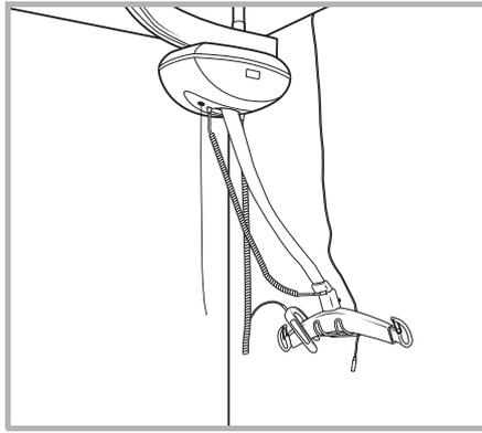
Prenda o controlo remoto à barra de suporte de modo que não haja tensão no cabo, o que poderia causar uma ejeção repentina. Enrole o excesso de extensão.
