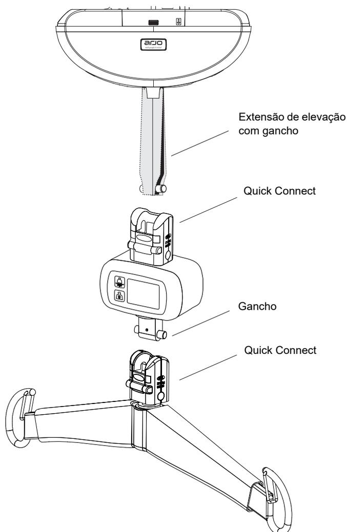
A barra de suporte e a balança incluem uma fixação que permite que o prestador de cuidados as mude em alguns passos sem utilizar quaisquer ferramentas.
