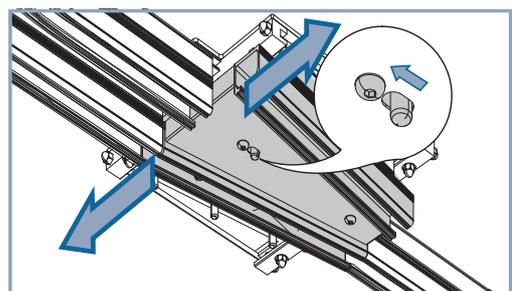
Caso o permutador não consiga funcionar automaticamente ou se existir uma situação de emergência, acione o sistema de libertação rápida localizado por baixo do permutador e faça deslizar a placa manualmente para mudar completamente a trajetória.
