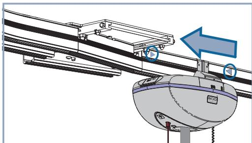
Leve a estação de ativação para junto do permutador. Posicione o elevador entre as marcas
