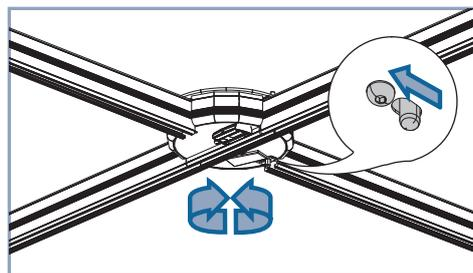
Caso o acessório *Turntable* não funcione automaticamente ou se ocorrer uma situação de emergência, acione o sistema de libertação rápida localizado por baixo do acessório *Turntable* e rode a placa manualmente para mudar completamente a trajetória.
